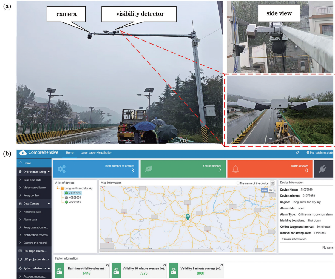
图 10 能见度监测点。(a)设备部署;(b)云平台监测
